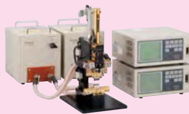
上下式脉冲电流加热装置 Upper and Bottom Pulse Heat Type
